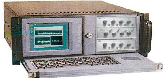
Dank spezieller patentierter Technologie ist es möglich Hochspannungen direkt ins PC-Gehäuse eingeben
